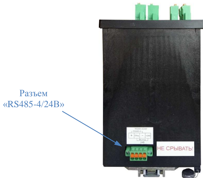
Рисунок 5.7 – Внешний вид КПП-01М (вид снизу) (модификация МИР КПП-01М-5(150)-230-4R2EBI-8TC24-2ТУ-ИП230-КQ)
